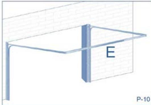
**Barra posterior:** Para el atado de las guías horizontales, asegurando la solidez del sistema y facilitando el escuadre de las guías. (figura 10, E)
