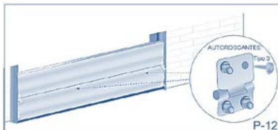
**Auto-centrado de bisagras:** pre-taladro de las bisagras para un ajuste rápido y cómodo (figura 12). Montaje rápido y funcionamiento sin ruidos.
