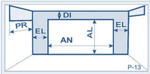
**EL:** Espacio lateral (para las guías.) El hueco mínimo necesario para la instalación es de 80 mm (K). En caso de montaje entre muros se recomienda un ancho mínimo de 100 mm (L).
